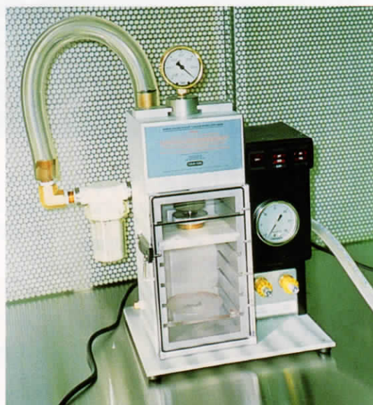
遺伝子組み換えに用いられるパーティクルガン
